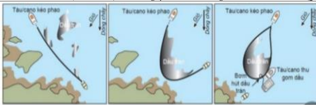
Hình 3.7. Quây chặn dầu tại vị trí ven bờ - Trong trường hợp vệt dầu loang trôi vào vùng nước nông ven bờ và có nguy cơ bám dính vào bờ, sử dụng kỹ thuật phao quây chặn theo hình tròn bằng phao quây dầu cỡ vừa để ứng phó nhanh
