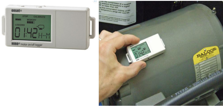
Hình B.11. Hình ảnh thực tế của Thiết bị theo dõi chu kỳ bật/tắt của động cơ (Motor On/Off Data Logger UX90-004)
