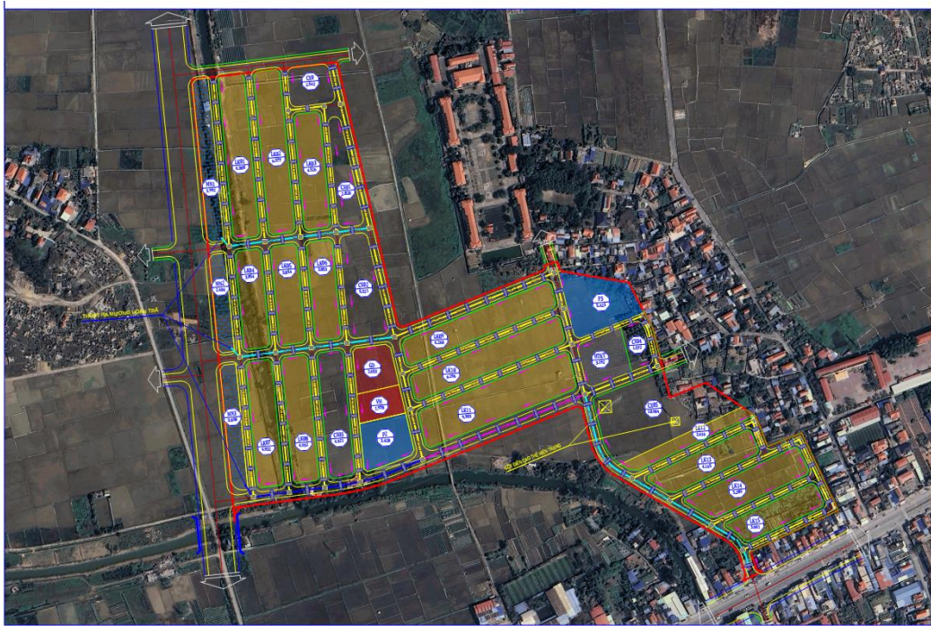
Hình 5. Mặt bằng thoát nước mưa
