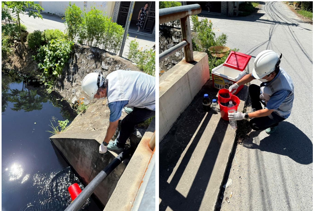
Hình 2.4. Hình ảnh quan trắc lấy mẫu nước mặt hiện trạng tại kênh Đò Vọ 1
