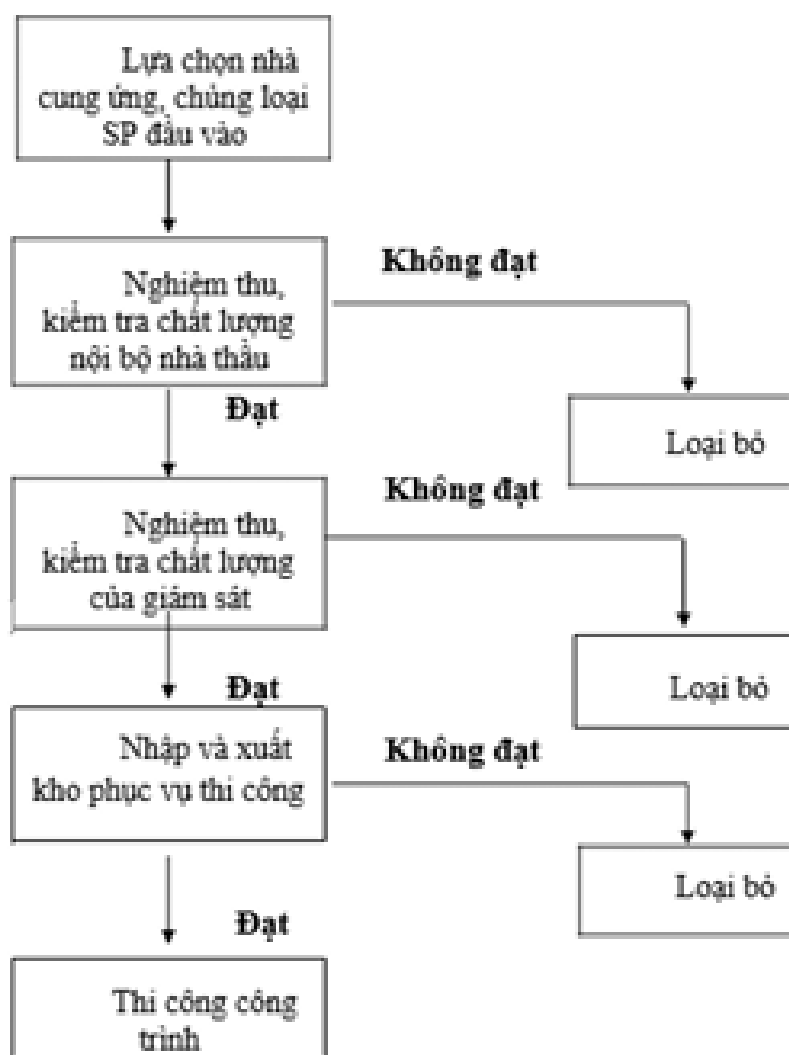
Hình 1.7. Sơ đồ quy trình quản lý chất lượng vật tư
