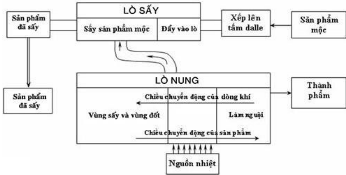
Hình 1.3. Sơ đồ nguyên lý hoạt động của lò nung-sấy Tuynel
