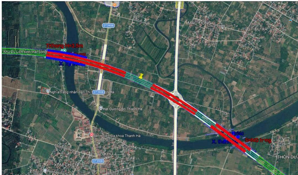
Hình 1.7. Mặt bằng thiết kế nút giao ĐT.390B và ĐT.390B tránh Thanh Hà
