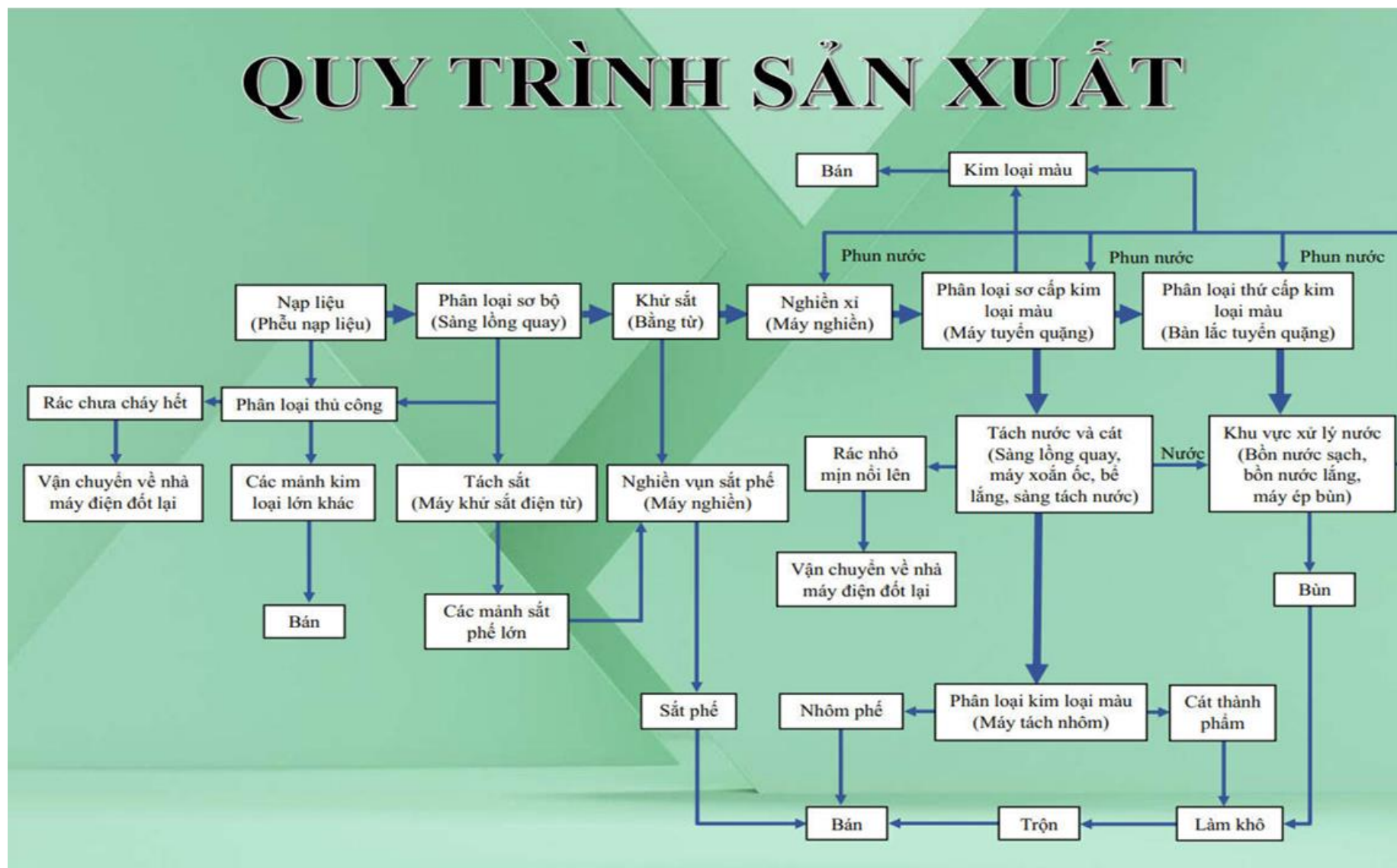
Hình 4.16: Quy trình công nghệ dây chuyền xử lý xỉ đáy lò
