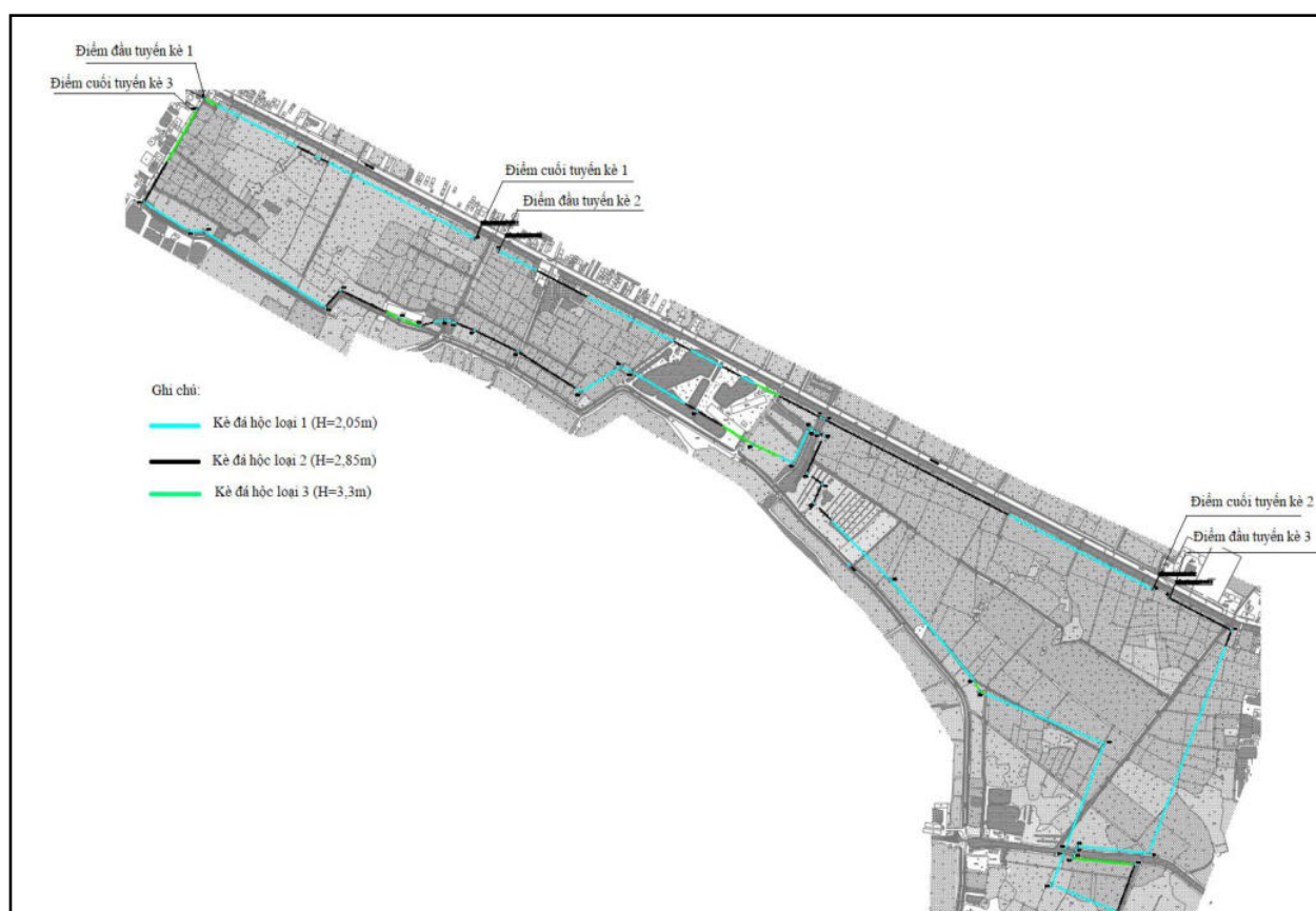
Hình 1.19. Tổng mặt bằng kè đá hộc
