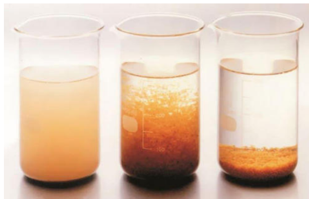
Quá trình keo tụ tạo bông trong xử lý nước thải
