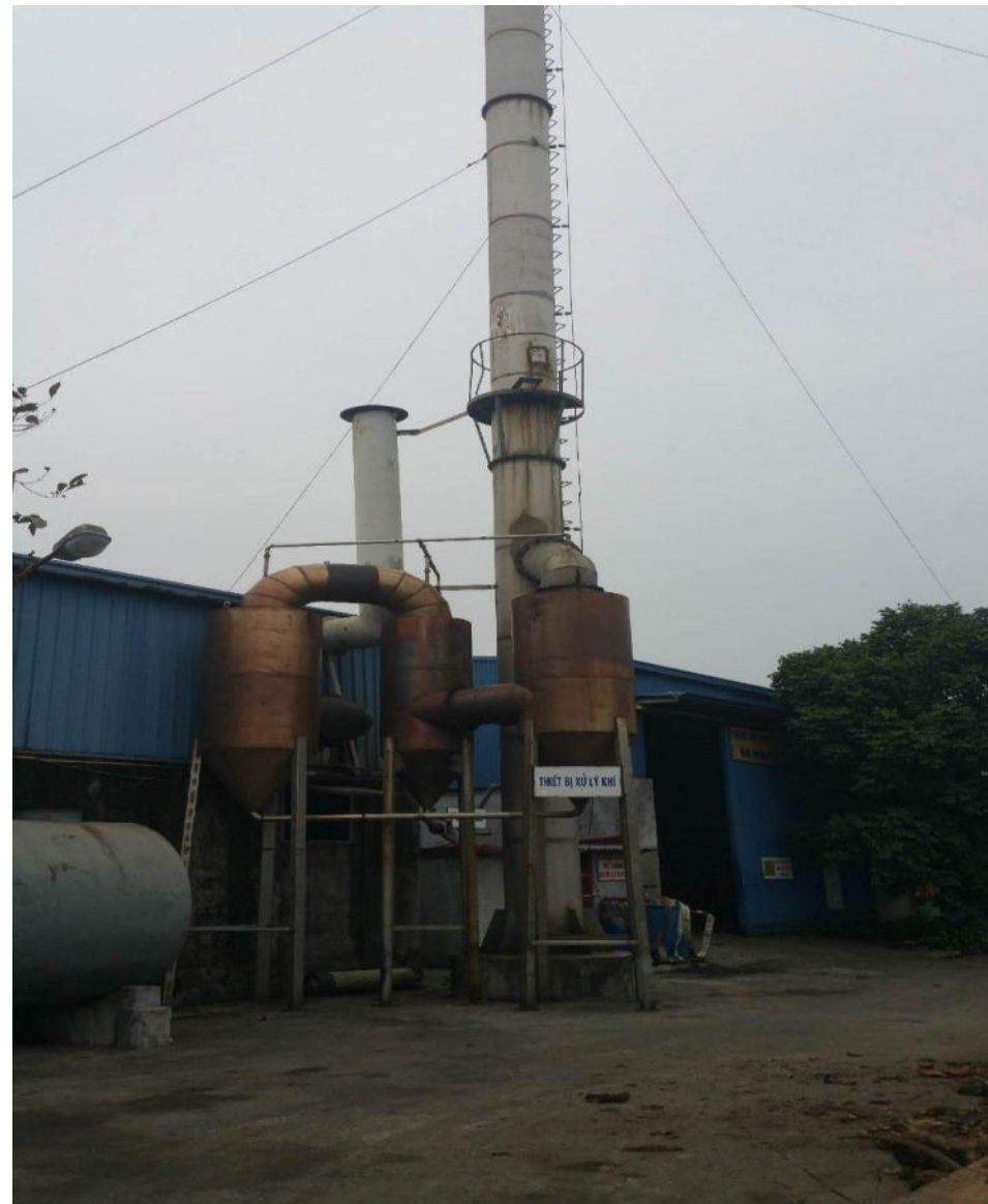
Hệ thống xử lý tuần hoàn nước làm mát và dung dịch hấp thụ để xử lý khí thải lò đốt chất thải nguy hại
