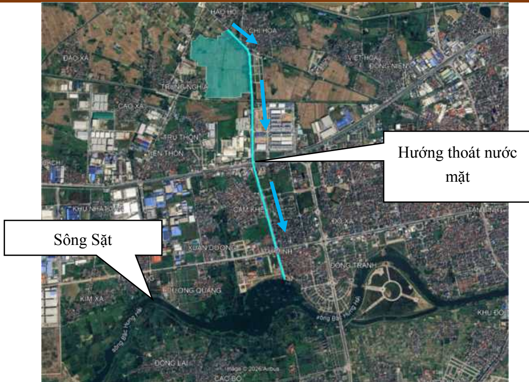
Hình 1. 10. Hước thoát nước mặt khu vực dự án
