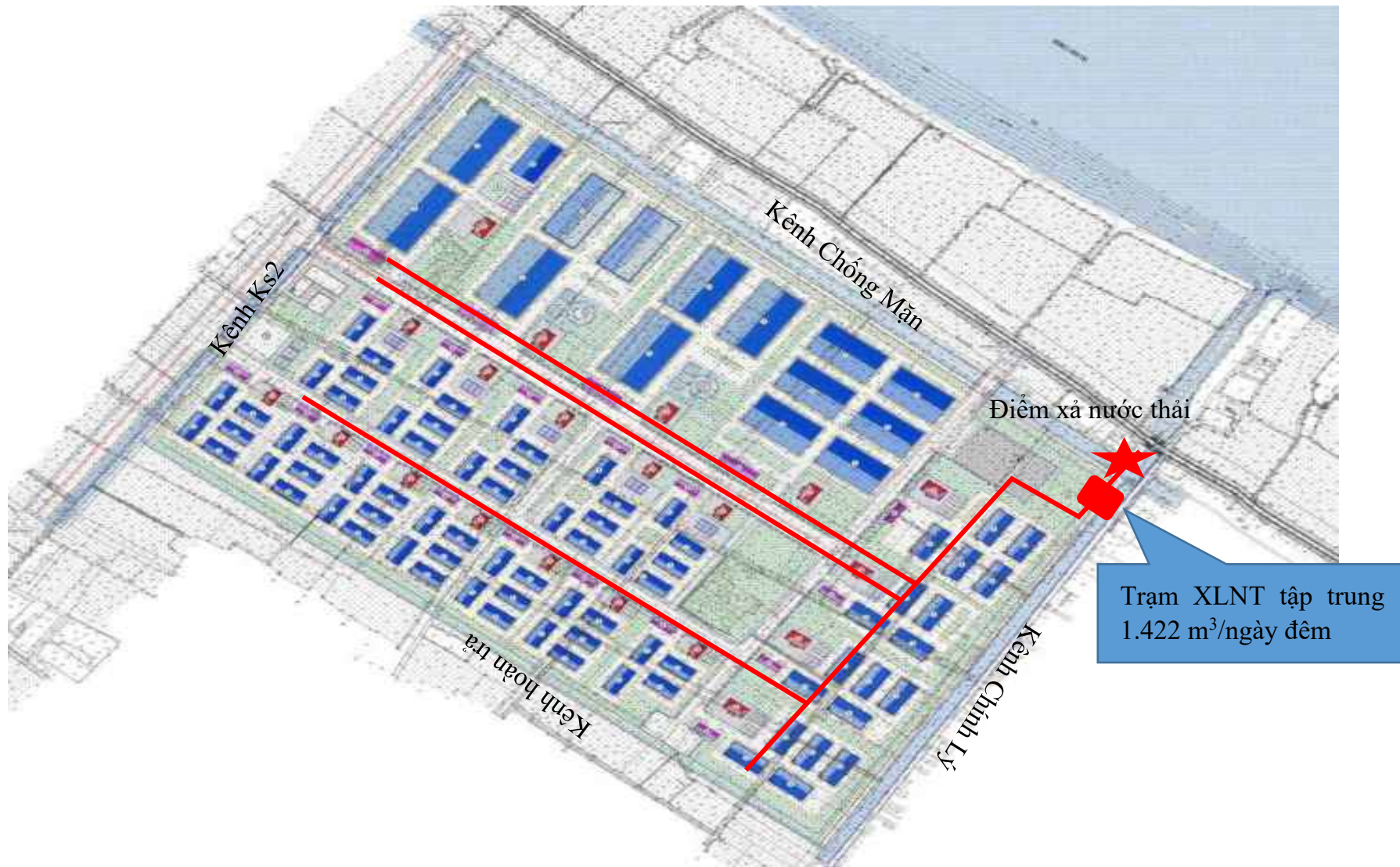
Hình 1. 19. Sơ đồ thu gom và thoát nước thải
