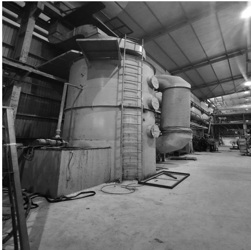
Hình 3.16. Hệ thống xử lý khí của dây chuyền ép tấm 1
