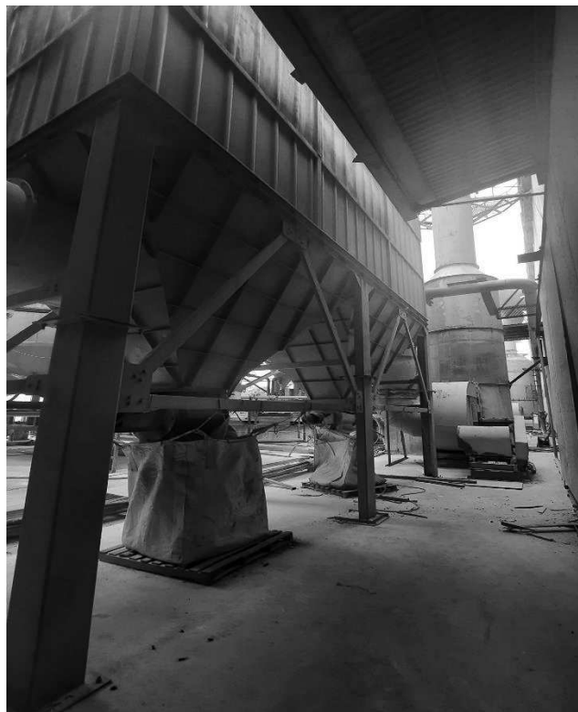
Hình 3.13. Hệ thống lọc bụi khu vực cân định lượng, phối trộn, rải liệu dây chuyền 1
