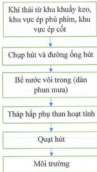
Hình 3.8. Quy trình công nghệ xử lý khí thải trong sản xuất bằng phương pháp tháp hấp phụ
