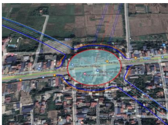
Giao lộ cùng cấp với đường tỉnh lộ 359
