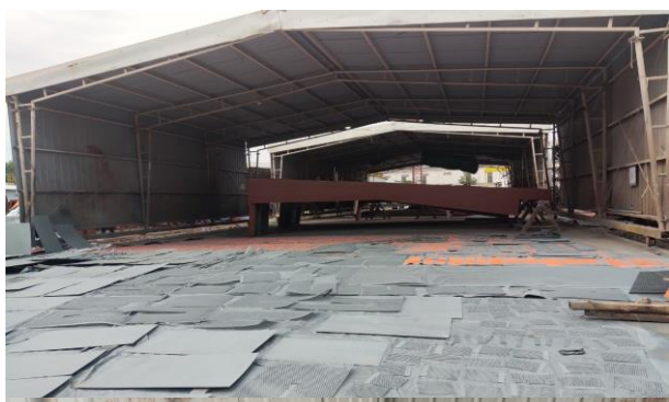
Nhà sơn di động và các tấm lót sàn được bố trí tại khu vực sơn
