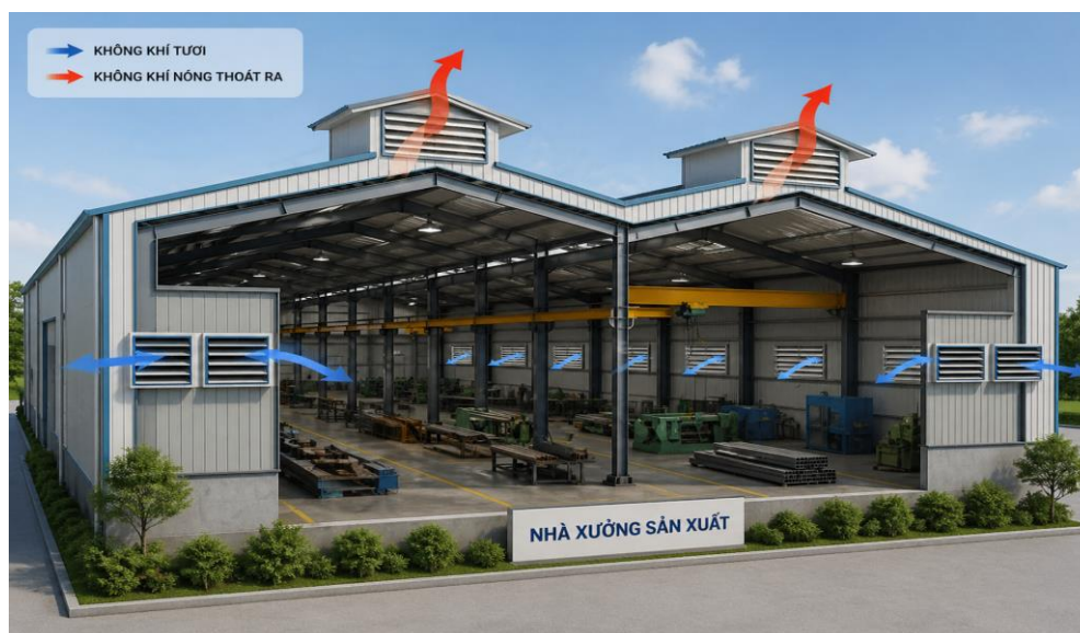
Hình 3.13. Mô hình thông gió cho nhà xưởng sản xuất
